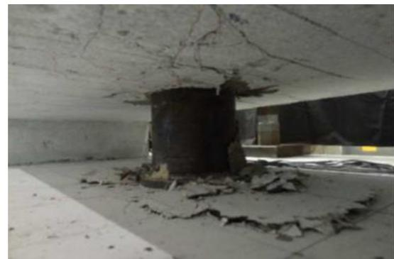
(c) SB-3 試験体(最終破壊状況)
