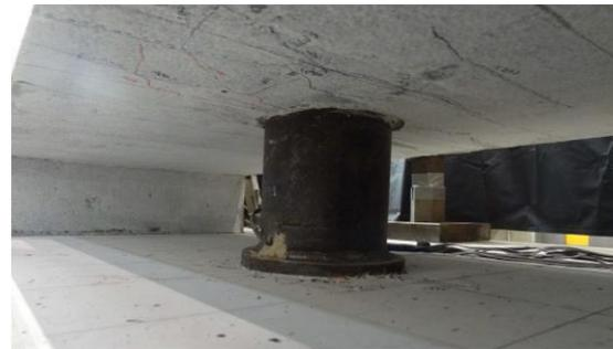
(b) SB-3 試験体(変形4mm時の状況)
