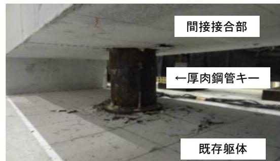
(a) SB-1 試験体(最終破壊状況)
