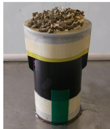
写真-2  $C=400 \text{ kg/m}^3$  で曝露 60 日の供試体
