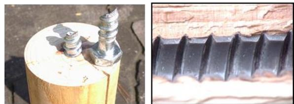
図-2 ラグスクリューの破断と樹脂の充填状況
