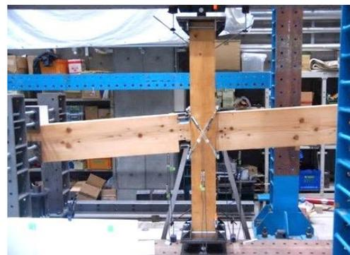
図-15 最大耐力時の変形状況(X-1)
